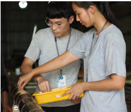
竹子開裂處可以用竹粉填塞，然後點快乾
